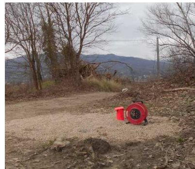
misura livello statico su S2 con Piezometro
