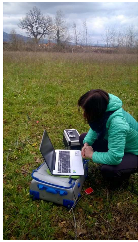
Misure in array sulla spalla A in destra Tevere
