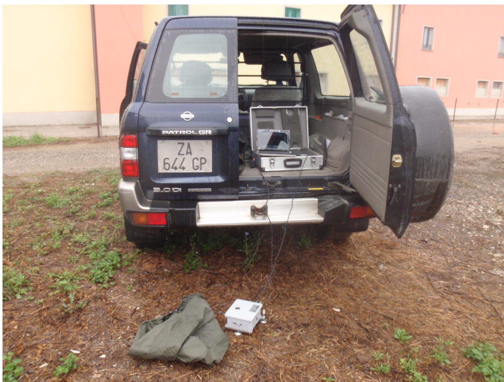
Particolare installazione stazione di misura HVSr1
