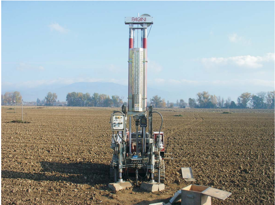
FOTO 1 : Strumentazione utilizzata per l'esecuzione della prova CPT 1.
