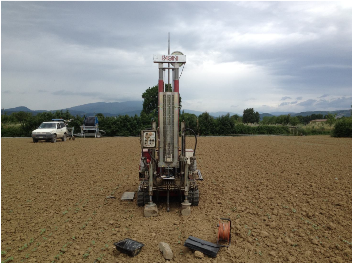
FOTO 1 : Strumentazione utilizzata per l'esecuzione della prova DPSH 3.
