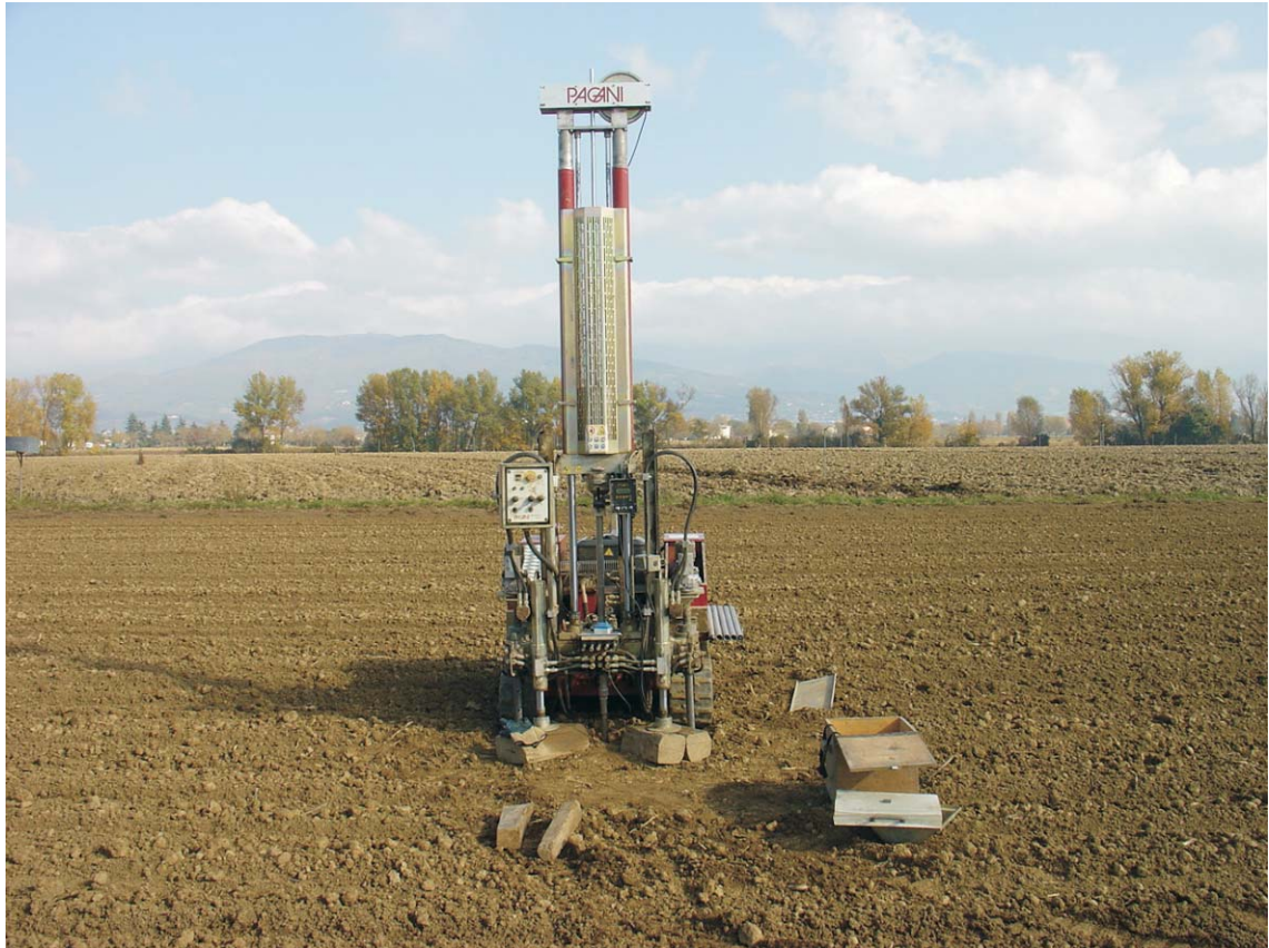
FOTO 1 : Strumentazione utilizzata per l'esecuzione della prova CPT 3.
