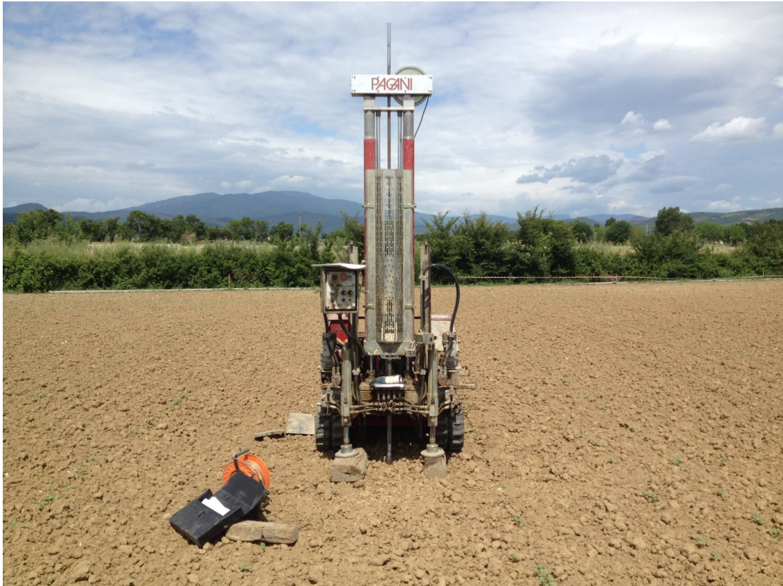
FOTO 1 : Strumentazione utilizzata per l'esecuzione della prova DPSH 1.
