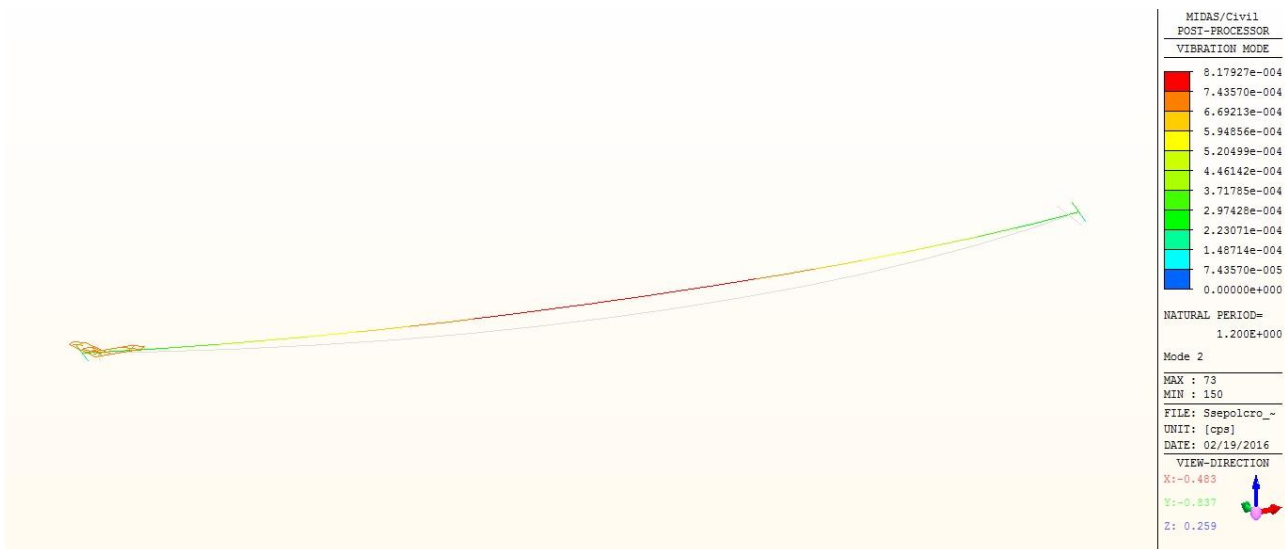
Figura 18: Secondo modo di vibrare - Trasversale
