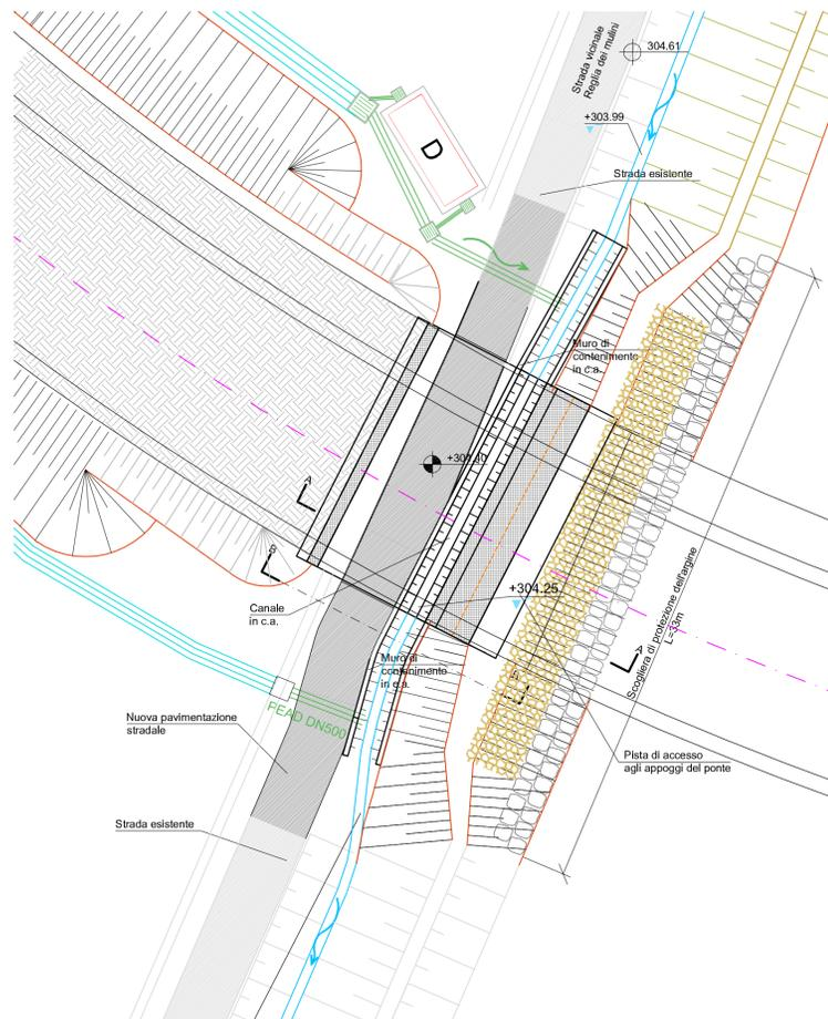
PLANIMETRIA SOTTOPASSO SPALLA B
