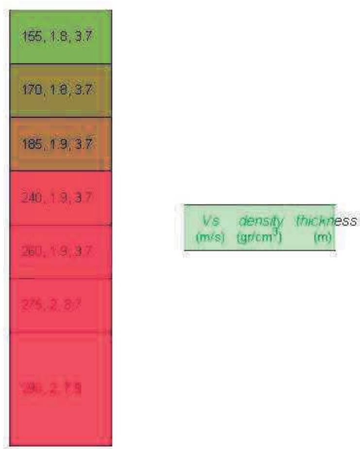
Colonna sismostratigrafica emersa dai dati MASW
