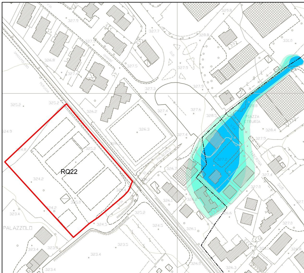
FOSSO DELLA GORGACCIA Carta delle aree allagate redatta ai sensi del D.P.G.R. 53/R del 25.10.2011 (scala 1:2.000)
