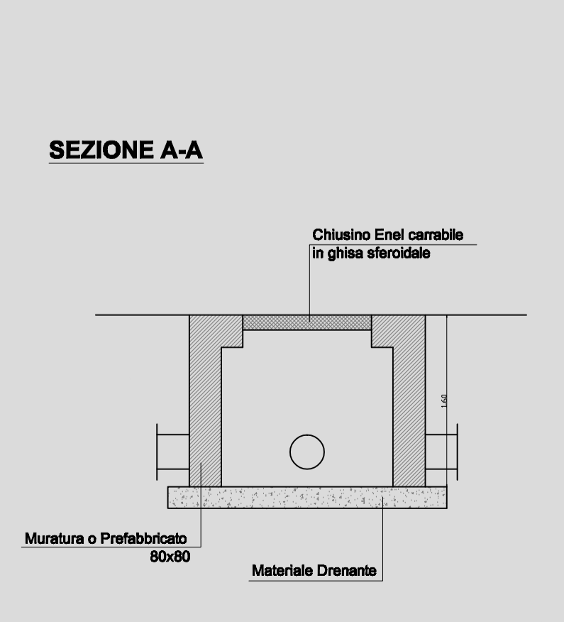
PARTICOLARE POZZETTO DI TRANSITO PER DERIVAZIONE 80X80 Rete Elettrica Scala 1:50
