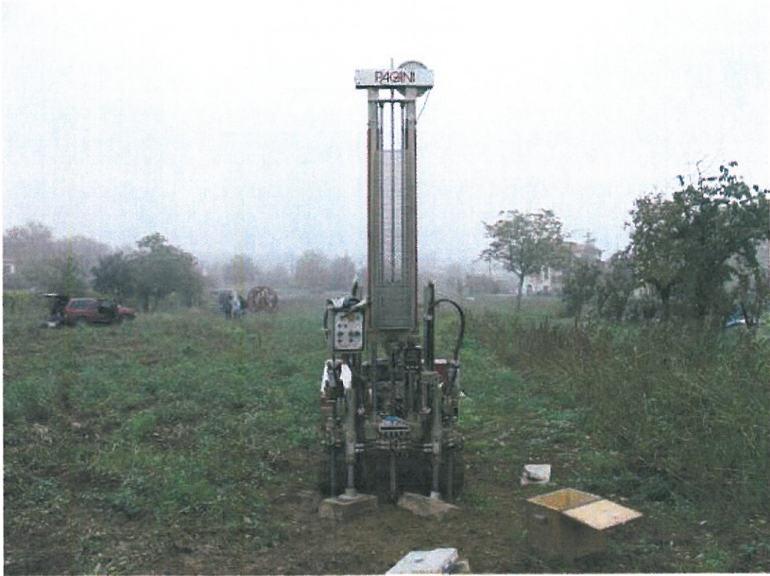
FOTO 1 : Strumentazione utilizzata per l'esecuzione della prova CPT 1.
